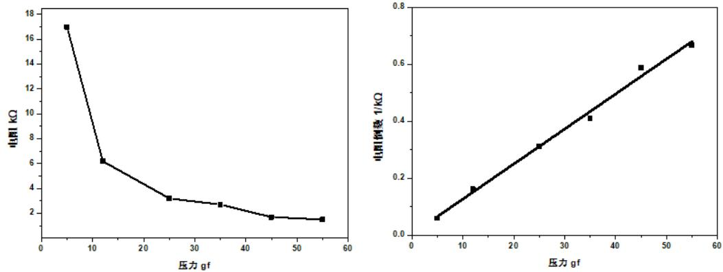
注意：压力传感器的输出阻值与多种因素有关，例如接触面积、测试仪器等。上述提供的图表数据仅供参考，建议用户根据实际应用场景进行标定，以获得更精准的测量结果。
